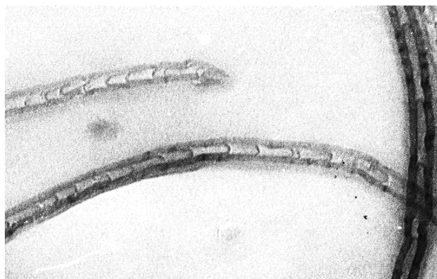
Рис.1. Фрагмент фотографии БУНТ полученной с помощью атомного силового микроскопа (СО ИРЭ РАН)
