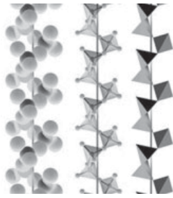
Рис. 2. Строение единичной спирали в структуре \alpha -кварца
