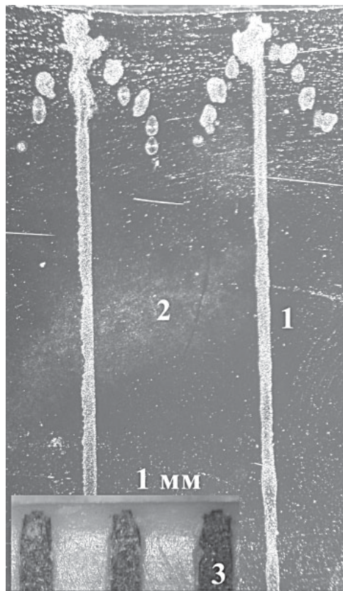
Рис. 5. Микроструктура, напечатанная суспензией наночастиц Sb_xSn_{1-x}O_2 на кремниевой подложке с помощью стандартного струйного принтера
