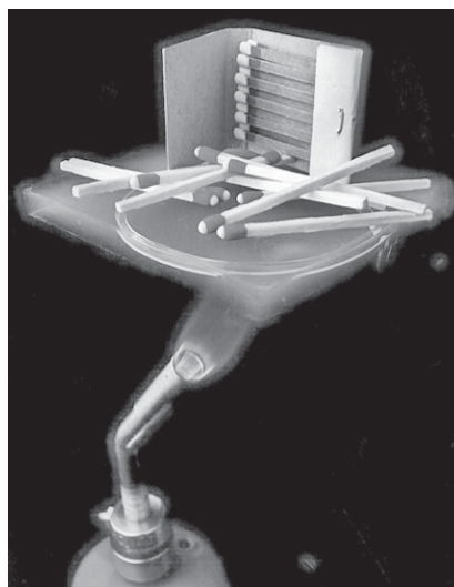
Демонстрация низкой теплопроводности аэрогеля
