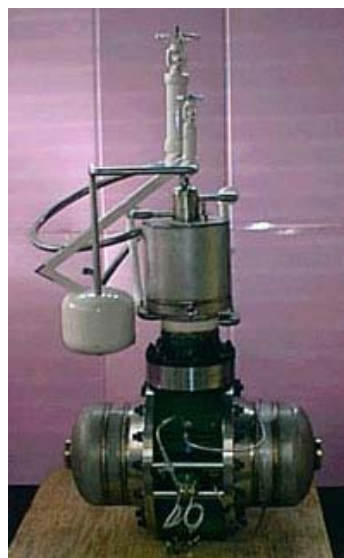
Рис. 1. Криокулер Q-drive 2S362K (1 кВт при 77 К).
