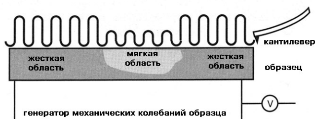
Рисунок 7-3 Амплитуда колебаний кантилевера изменяется в зависимости от механических свойств поверхности образца.
