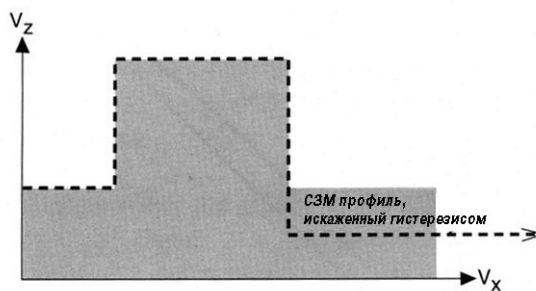
Рисунок 2-5 Влияние гистерезиса на измеренный профиль ступеньки.
