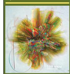
"Морская живность" - сложные друзы электропроводящих нитевидных кристаллов ванадиевых бронз, полученных гидротермальной обработкой (оптическая микроскопия в поляризо-
