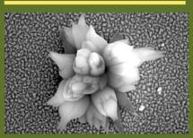
"Фуллеритовый цветок". При хранении на воздухе на поверхности двухслойных пленок олово-фуллерит, полученных методом вакуумного термического напыления, под действием сжимающих напряжений появляются фуллеритовые кристаллы, по внешне-му виду напоминающие цветы. Хотя длина отдельных лепестков может достигать 10 мкм, их толщина составляет 20-40 нм. Фотографии получены на сканирующем электронном микроско-пе LEO 1455 VP.
