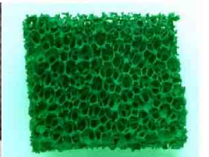
«Двумерная» ткань (2D) из оксида иттрия (слева) и «трехмерная» пена (3D) из «зеленой фазы» Y_2BaCuO_5 (справа) перед их пропиткой расплавом – исходные заготовки для «формосохраняющей» технологии получения ВТСП
