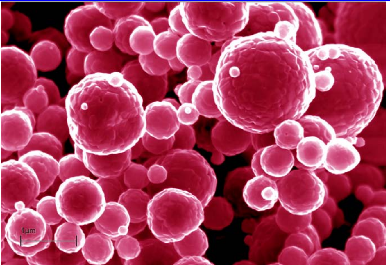
«Наномалина» - оксидный продукт пиролиза ультразвуковых аэрозолей нитратных растворов солей 3d – элементов.
