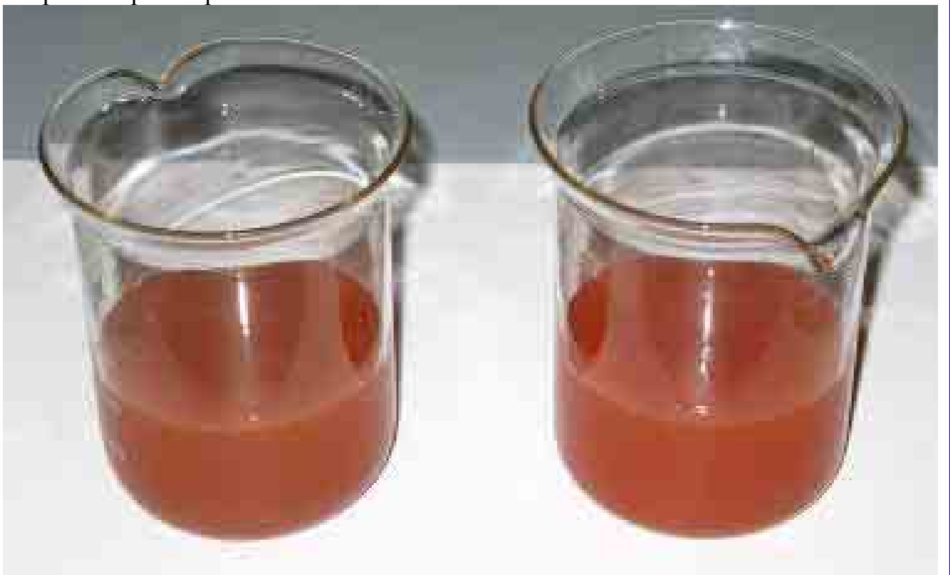
Нетоксичная стабильная суспензия магнитных наночастиц после растворения «соляных капсул» в воде.
