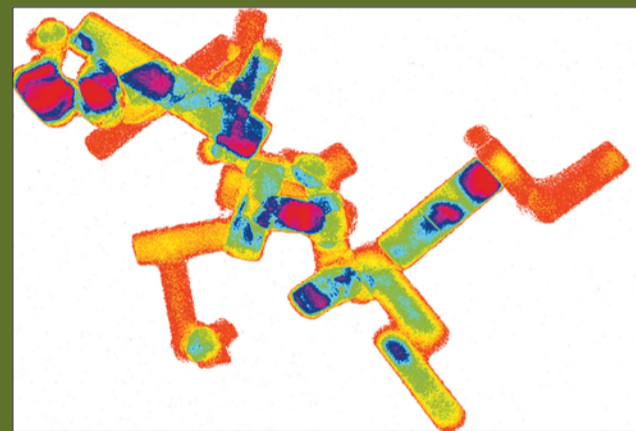
"Механистический материализм". Диоксид циркония, полученный в гидротермальных условиях. Просвечивающая электронная микроскопия. Авторы - В.Иванов, А.Баранчиков (ИОНХ РАН им. Н.С.Курнакова).
