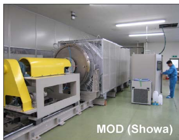
Рис. 1. Японское оборудование для осаждения буферных слоев и слоев ВТСП, рассчитанное на изготовление до 500 м провода.
