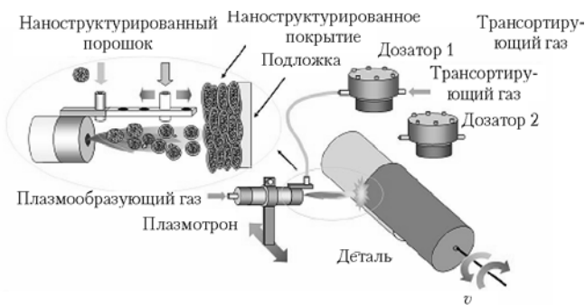
Рис. 14. Схема технологического процесса микроплазменного напыления наноструктурированных покрытий
