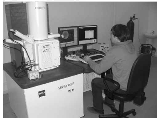
Фото 4. Многофункциональный аналитический растровый электронный микроскоп «Карл Цейсс» Supra 40 (разрешение 1 нм). Микроанализ, охлаждение до гелиевых температур, Катодолюминесцентная спектроскопия
