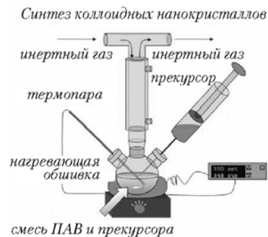
Рис. 10. Схема установки для проведения гидролиза золя при получении наноразмерных порошков
