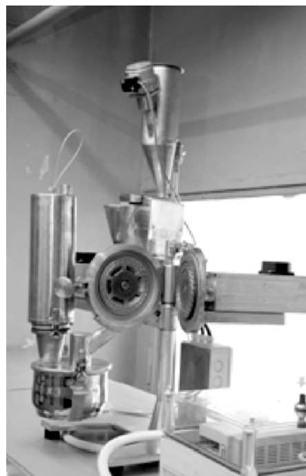
Рис. 5. Высокоскоростной воздушный дезинтегратор Д18 с частотой вращения роторов 300\text{ с}^{-1}
