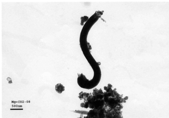
Рис. 8. ТЕМ продуктов горения магния в CO_2 . Видны геликонизированные наноструктуры сложенные в монолитный жгут
