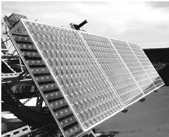
Концентраторные солнечные батареи (4 модуля, площадью 0,5×0,5 м каждый) на основе гетероструктурных фотопреобразователей и линзовых концентраторных панелей
