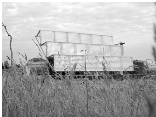
Концентраторная фотоэнергоустановка на основе каскадных фотоэлементов и линз Френеля (ФТИ им. А. Ф. Иоффе РАН)
