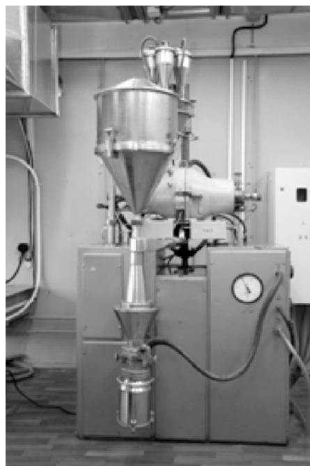
Рис. 6. Высокоскоростной дезинтегратор 1А5 для работы в среде инертных газов и вакууме с частотой вращения роторов 400\text{ с}^{-1}
