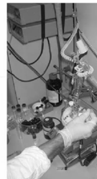
Рис. 10. Схема установки для проведения гидролиза золя при получении наноразмерных порошков
