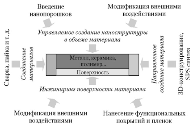
Рис. 2. Основные подходы в получении конструкционных наноматериалов
