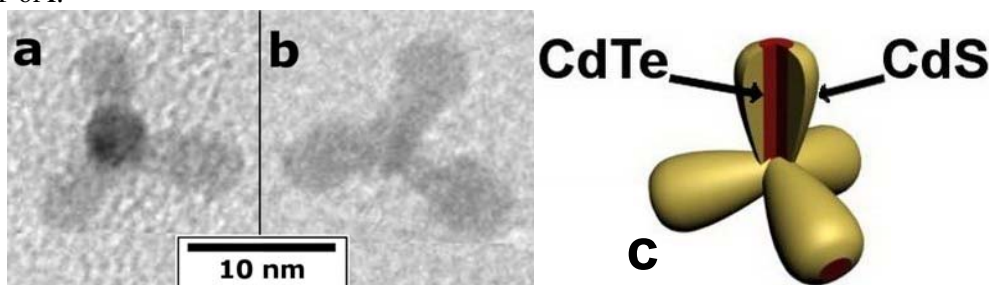
Рисунок 3. Микрофотографии наночастиц CdTe (а) и CdTe/CdS (б), полученные методом просвечивающей электронной микроскопии, (с) – схематическое изображение наногетероструктуры CdTe/CdS.
