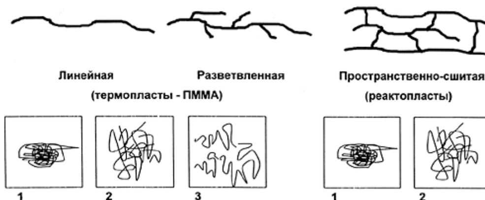
Рис.12 Различные конфигурации молекулярной структуры полимера
