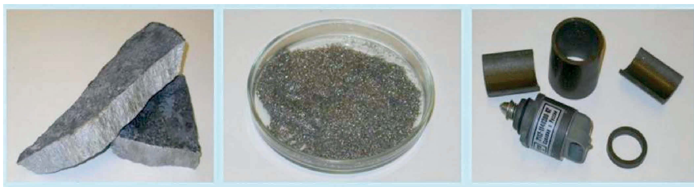
Рис. 1. Магнитные нанокомпозиты: а – слитки; б – аморфный порошок; в – изделия
