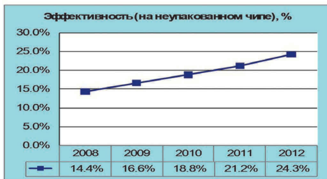
Рис. 5. Прогноз разработок LED в России. Характеристики чипов и светодиодов (ЗАО «Оптоган»)
