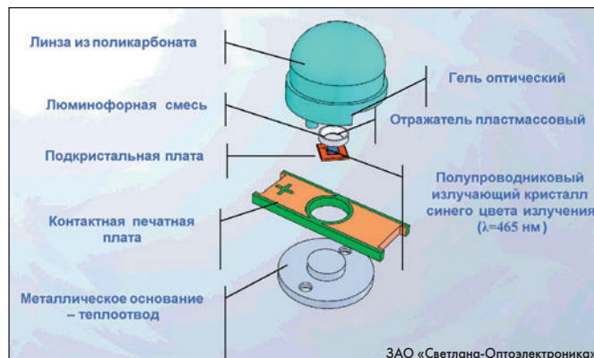
РИСУНОК 2 | Схема светодиода, выпускаемого ЗАО «Светлана-Оптоэлектроника»
