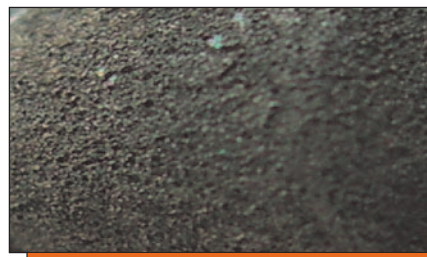
РИСУНОК 2 | Пористая поверхность металлического каркаса зубного протеза, подготовленная для нанесения композиционного покрытия (увеличение микроскопа – 40 раз)
