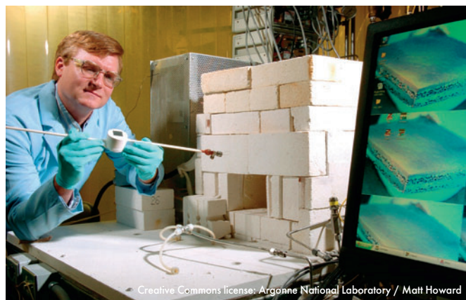
Исследователь Дэвид Картер из Аргоннской национальной лаборатории, США, готовит твердооксидный топливный элемент для тестирования при высоких температурах
