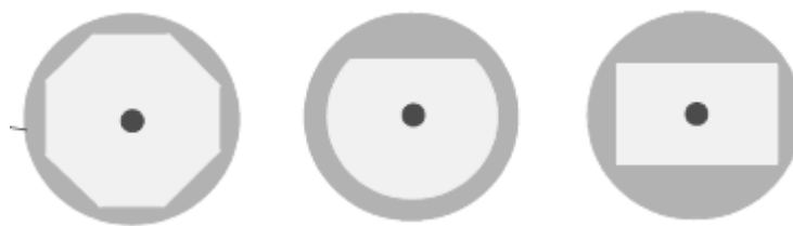
Рисунок 2.7 – Геометрия накачки во внутренние оболочки некруглых форм
