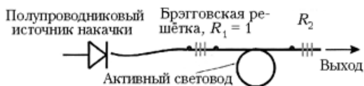
Рисунок 2.1 – Схема волоконного лазера
