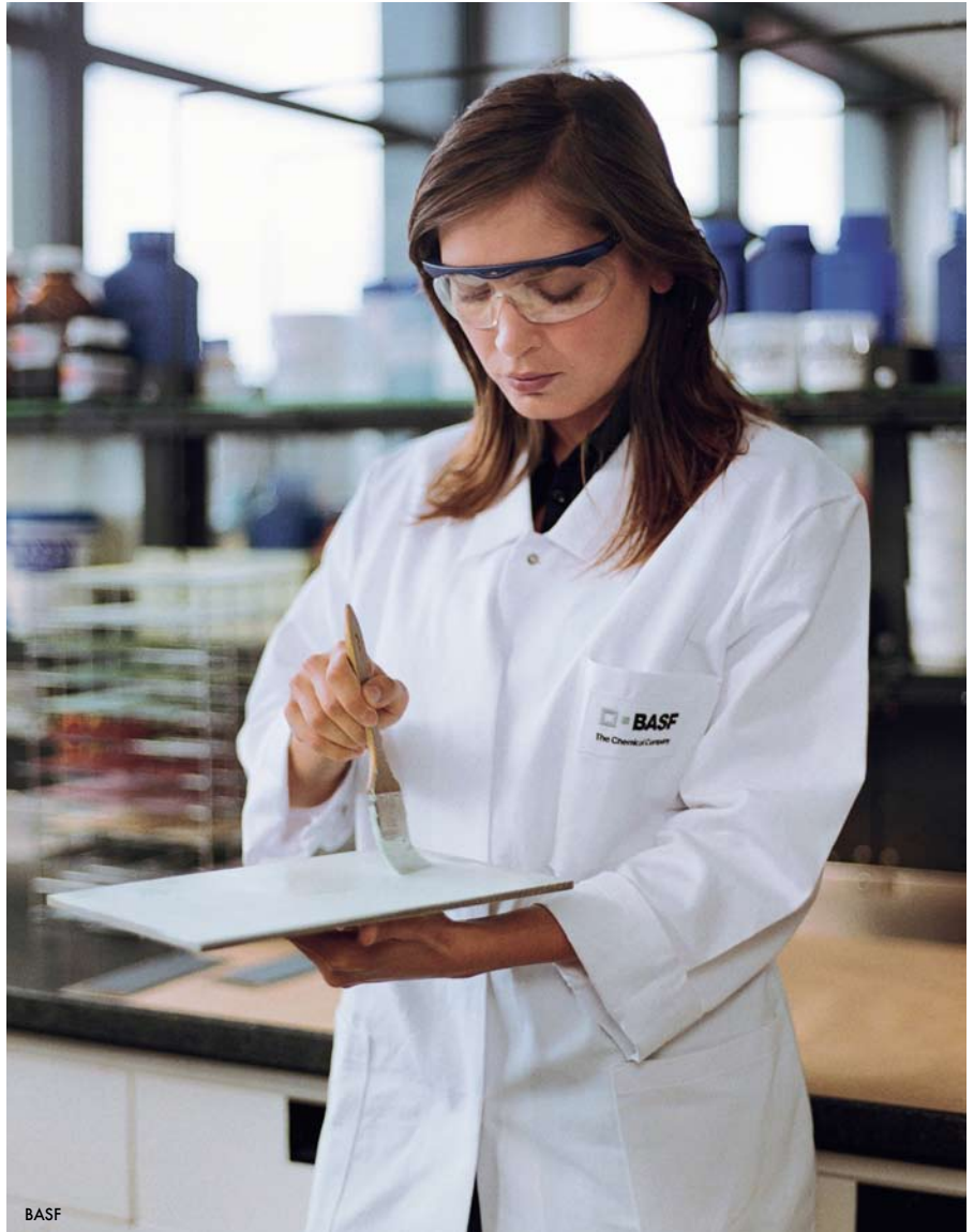
Цементную плитку покрывают краской на основе нанокompозита, что делает ее стойкой к непогоде
