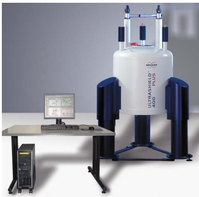
Рис. 3. Сверхпроводящие ЯМР спектрометр на 400 МГц (слева) и гиротрон на 263 ГГц (справа), Bruker Biospin.
