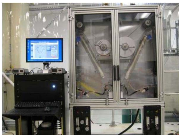
Рис. 3. Установка для нанесения выравнивающего слоя с термической обработкой, осуществляемой in situ .
