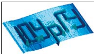
Нанонадпись на кварцевом стекле: глубина букв 70 нм, размер поля 10x20 мкм
