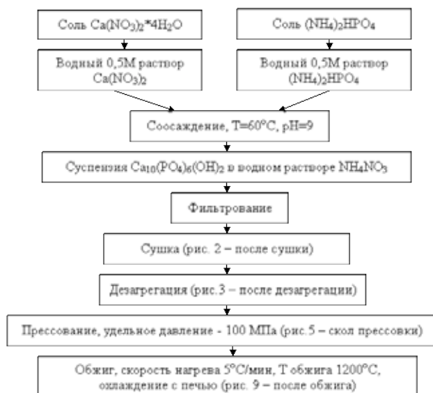
Рис.1. Схема получения керамики на основе гидроксиапатита.
