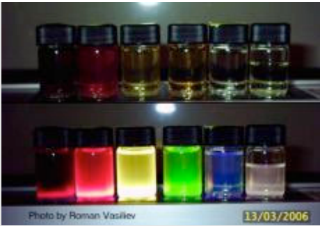
Свечение квантовых точек на основе селенида кадмия
