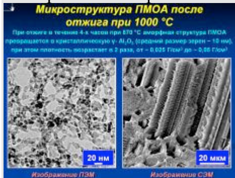
Микроструктура после отжига при 1000 °С.
