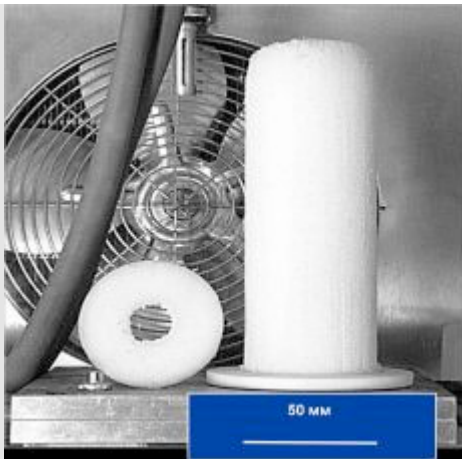
Макроблок из нановолокна гидратированного оксида алюминия
