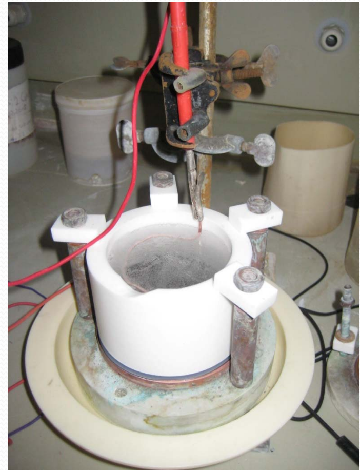
Ячейка для травления пористого кремния.
