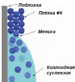
Рис. 5. Схема метода вертикального осаждения.
