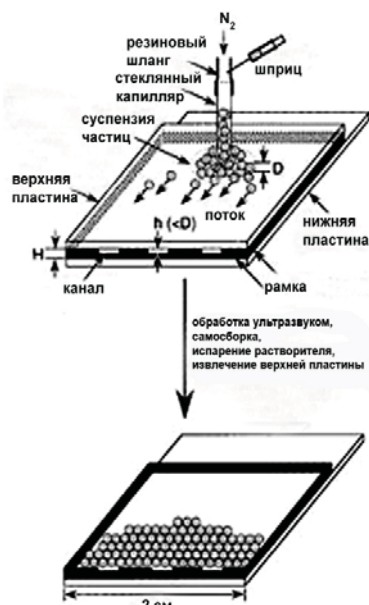
Рис. 6. Схема экспериментальной установки, использованной для получения коллоидных кристаллов из полистирола методом упорядочения частиц под давлением.
