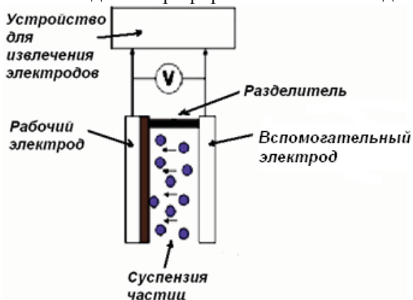
Рис. 8. Схематическое представление метода электрофоретического осаждения.
