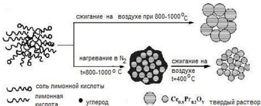
Схема 1. Синтез твердого раствора Ce 0,8 Pr 0,2 O y цитратным методом [13].
