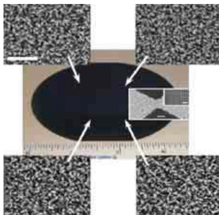
Рис 6. РЭМ-микрофотографии наностержней ZnO, полученных на кремниевой подложке радиуса 5 см, стрелками показано место съемки, Отметки на шкале 1 и 10 мкм, соответственно [17].
