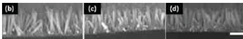
Рис 5. РЭМ-микрофотографии образцов оксида цинка, полученного в работе [17] с помощью (b) конвекционного нагрева в течение 90 мин (c) микроволнового нагрева при 120 Вт в течение 30 мин (d) микроволнового нагрева при 700 Вт, время - 6 мин. Отметка на шкале 200 нм
