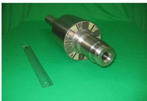
Рис. 4 – Двигатель ДС-150 (а – фото двигателя; б – вал ротора с напрессованным пакетом до установки магнитов; в – ротор с установленными постоянными магнитами и ВТСП пластинами; г – двигатель ДС-150 во время испытаний)
