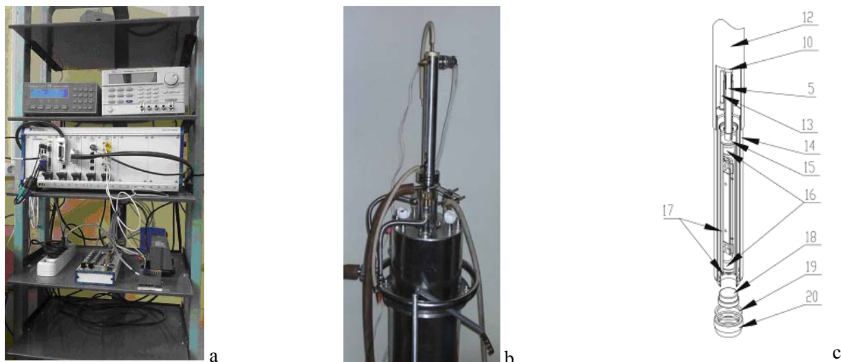
Рис. 2. Основная стойка стенда для измерения параметра RRR (а); испытательный зонд установлен в криостат (б); схема нижней части измерительного зонда с камерой стабилизации температуры (с).
