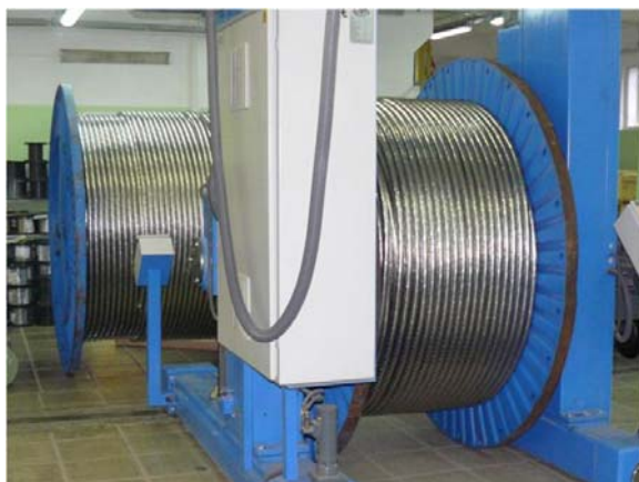
Рис. 2. Тубулярная крутильная машина и готовая скрутка.
