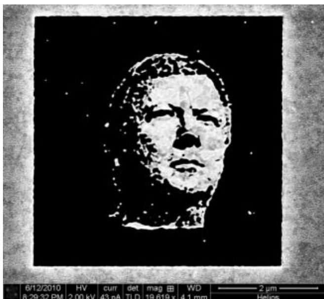
На этом небольшом кусочке кремния показана "гравюра" генерального директора РОСНАНО А.Б.Чубайса, полученная с помощью специального электронного микроскопа, оснащенного сфокусированным ионным пучком. Чем может быть (скорее всего) "выложено" изображение?
