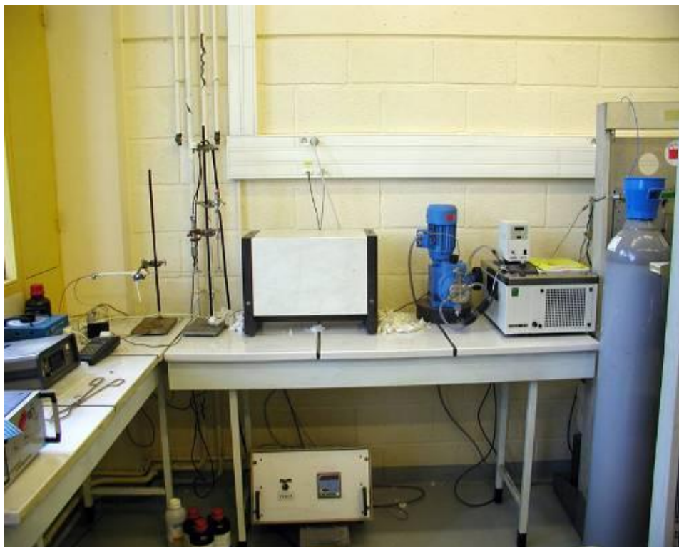
Установка для сверхкритической сушки (кафедра неорганической химии, Химический факультет МГУ им.М.В.Ломоносова)
