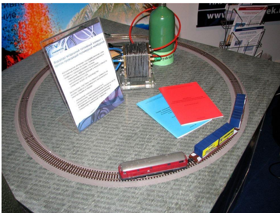
Игрушечный электропоезд, движение которого питается водородно-воздушным топливным элементом (фотография со второго Фестиваля Науки г. Москвы в МГУ)
