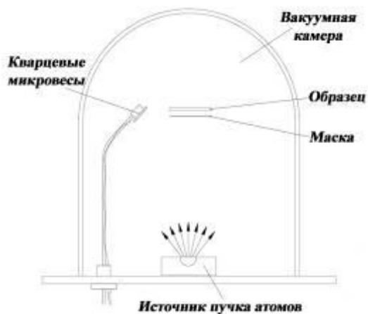
Установка для масочного нанесения элементов интегральных схем.
