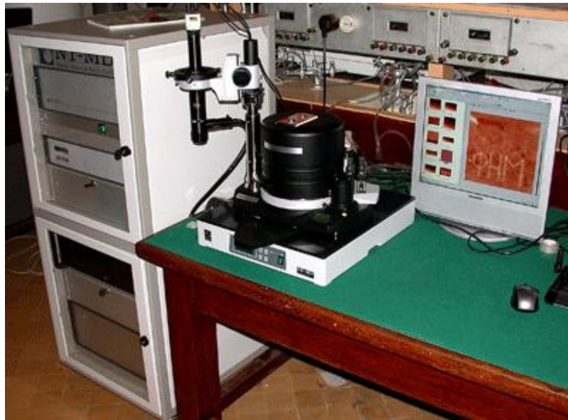
Сканирующий зондовый микроскоп NT-MDT NTEGRA Aura (NT-MDT, Россия)
