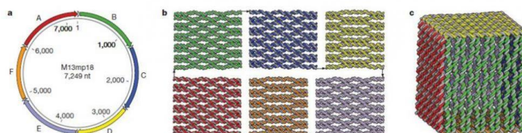
Рис. 2 - Схема создания наноскатулки. (а) ДНК бактериофага M13; (b) после добавления первой порции олигонуклеотидов формируются прямоугольники боковых граней, (c) которые затем при помощи второй порции олигонуклеотидов собираются в наноскатулку.
