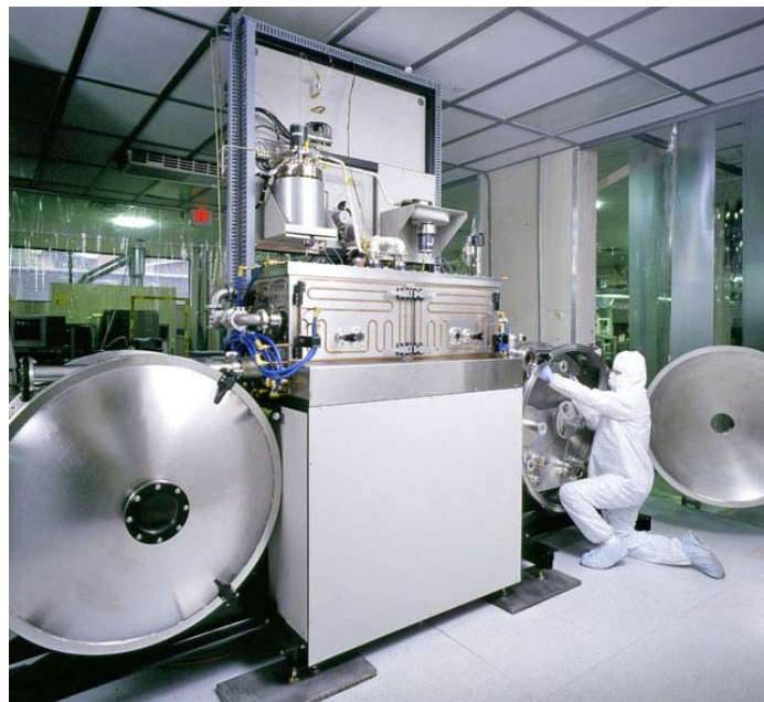
Рис. 5. Промышленная установка MOCVD для осаждения слоя ВТСП (SuperPower).
