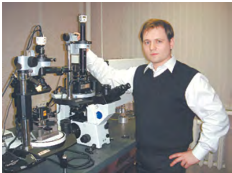
Нанолaborатория ИНТЕГРА Спектра предназначена для исследования эффектов взаимодействия света с веществом в масштабе нанометров. Большинство современных технологий нанофотоники основано именно на необычных субволновых свойствах света.
