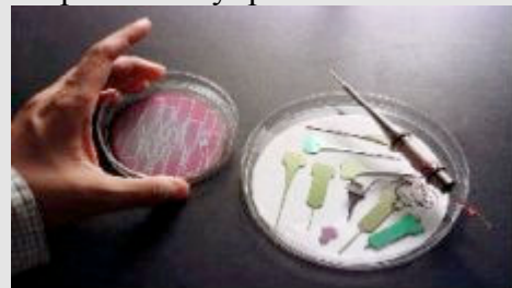
Рис. 26. Ультразвуковой режущий инструмент, изготовленный по технологии микрообработки
