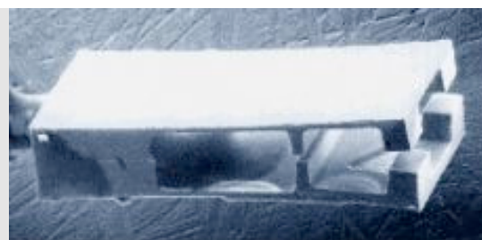
Рис 21. Микрозажим, приводящийся в действие силами сплава памяти формы
