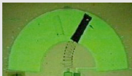
Рис 20. Магнитный микроактюатор, управляющий простейшим одноклеточным
