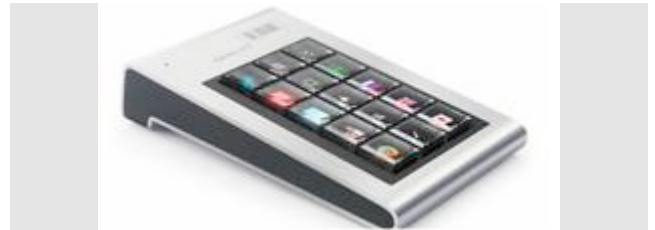
В клавиатуре "Оптимус" каждая клавиша является отдельным дисплеем, отображая именно то, чем она управляет в данный момент
