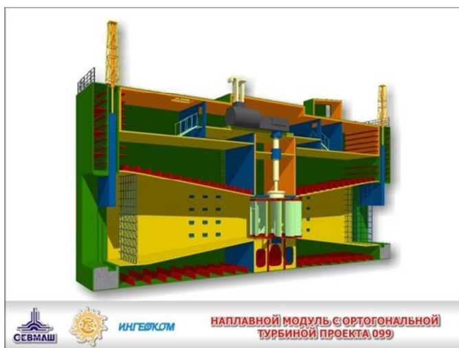
РИС. 1 ВНУТРЕННЕЕ УСТРОЙСТВО НАПЛАВНОГО МОДУЛЯ ДЛЯ ПРИЛИВНОЙ ЭЛЕКТРОСТАНЦИИ.
