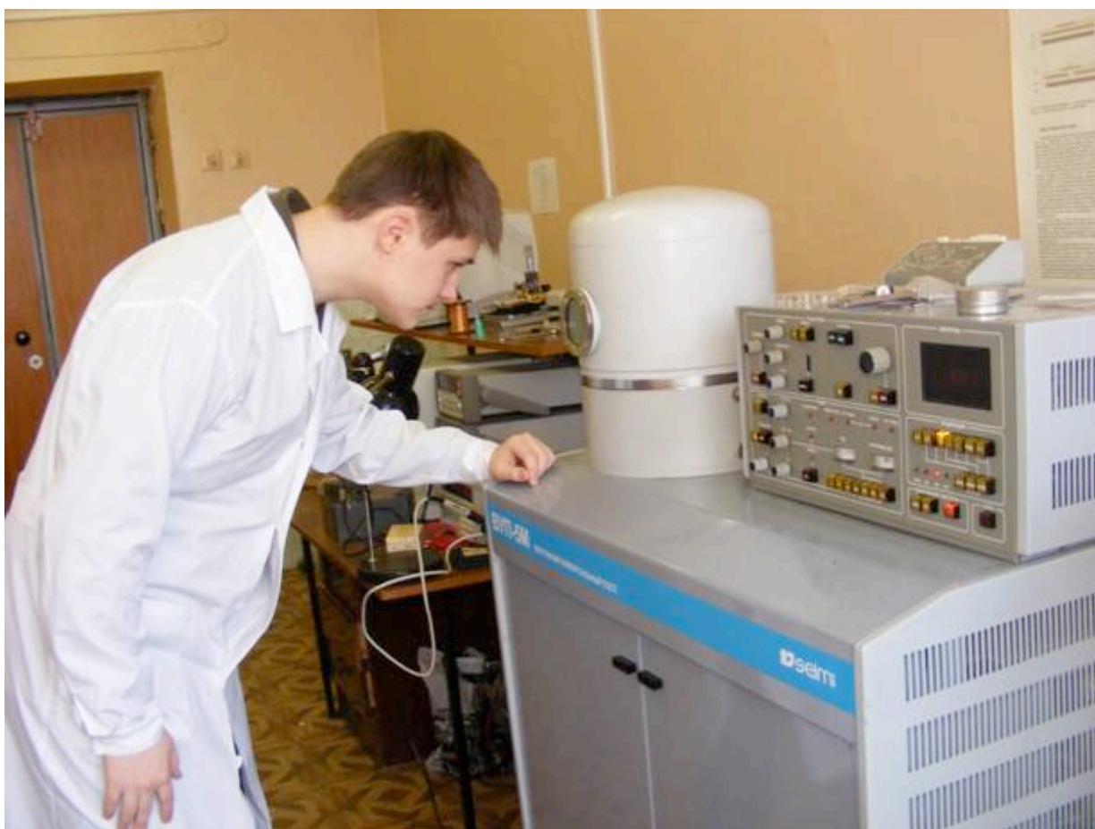
Контроль процесса напыления электродов, ВУП-5М
