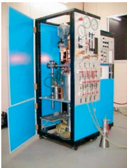
Рисунок 10. Внешний вид установки для получения субмикронных и наноразмерных частиц металлов, сплавов и оксидов металлов МИГЕН-2005
