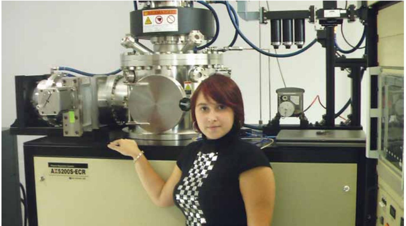
Рисунок 7. Установка плазмохимического газофазного роста алмазных пленок ASX5200S-ECR (Seki Technotron, Япония)
