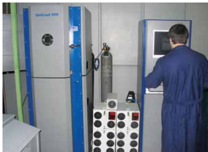
Рисунок 6. Автоматизированный комплекс нанесения упрочняющих нанокompозитных покрытий UniCoat 600 (Россия)
