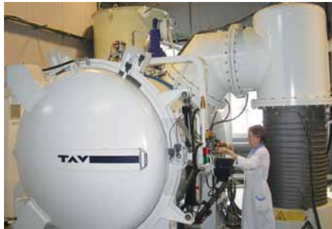
Рисунок 4. Вакуумная печь TAV H8 для высокотемпературного спекания и термообработки (Италия)
