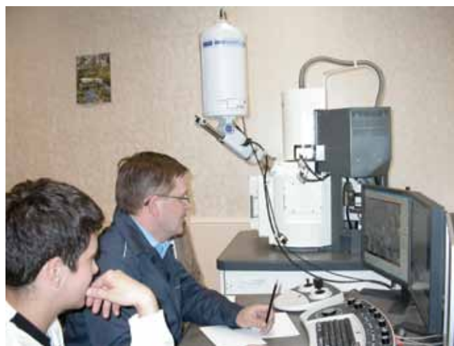
Рисунок 2. Аналитический автоэмиссионный растровый электронный микроскоп ULTRA 55 с приставкой EDX-анализа (Carl Zeiss, Германия)
