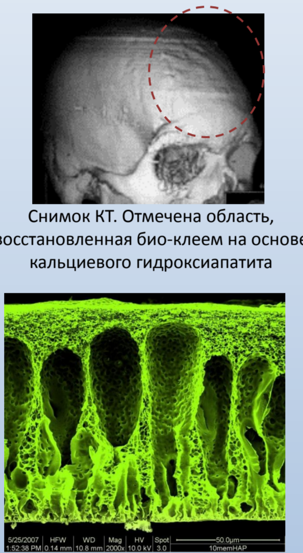
Микрофотография пористой биосовместимой керамики
