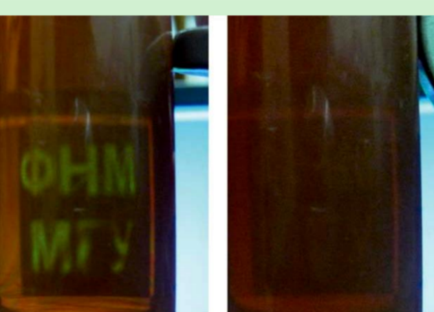
Варьирование прозрачности магнитной жидкости при изменении направления магнитного поля
