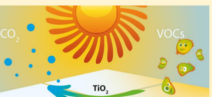
Схема работы фотокатализа: адсорбированные на поверхности бактерии окисляются под действием солнечного света
