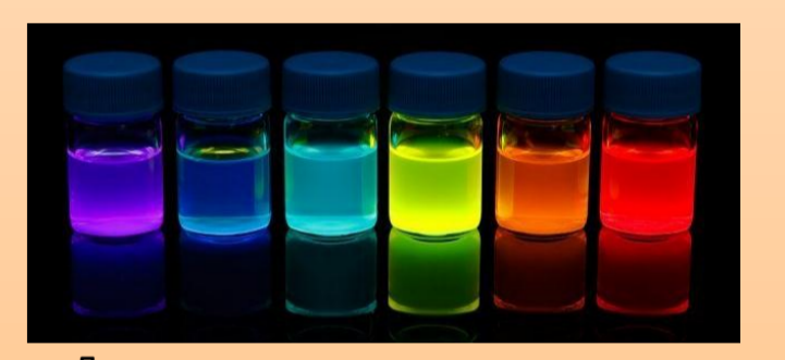
Люминесценция квантовых точек. Спектр варьируется в зависимости от размера частиц
