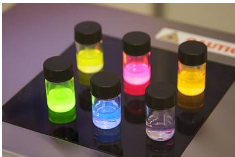
Рис. 3 Флуоресценция взвесей квантовых точек разного размера при облучении ультрафиолетом [7].
