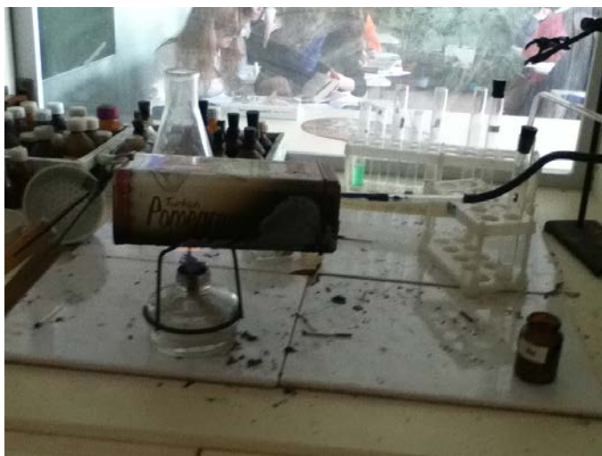
рис. 2.5. Прокаливание образца в присутствии водорода
