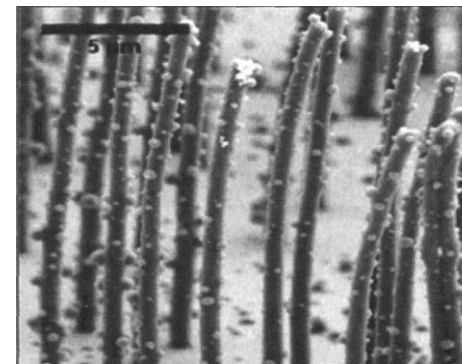
Рис. 2. Железные наностержни, имитирующие биологические реснички
