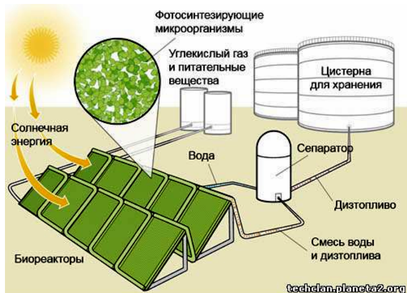
Рис. 119. Система биореакторов «топливная ферма» поглощает солнечный свет и, потребляя углекислый газ и питательные вещества, производит биотопливо в ходе фотосинтеза. Сепаратор разделяет продукты жизнедеятельности сине-зеленых бактерий, отбирая дизельное топливо и возвращая воду обратно в систему
