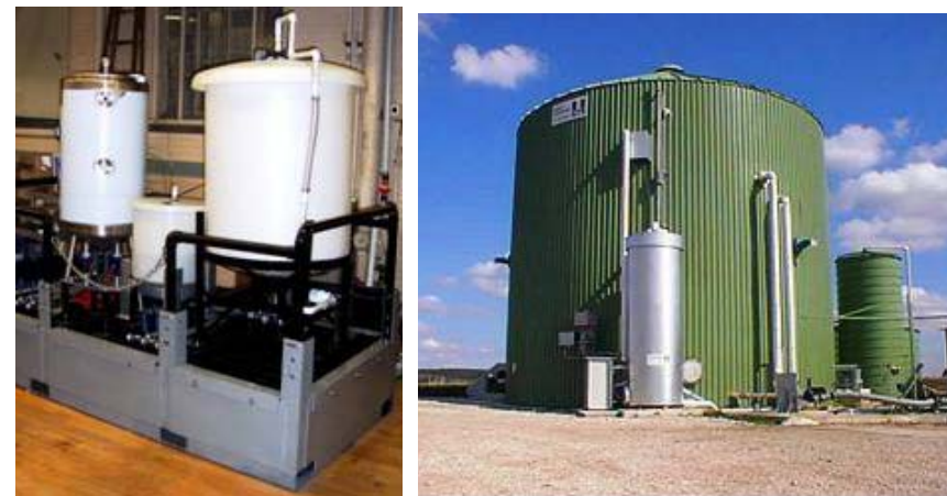
Рис. 118. Опытный (слева) и промышленный (справа) биореакторы
