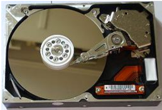
Рис. а) Устройство магнитного жесткого диска: видна пластина и головка, производящая чтение и запись информации. б) Пример зависимости графика скорости последовательного чтения от доли пройденной поверхности для реального жесткого диска.
