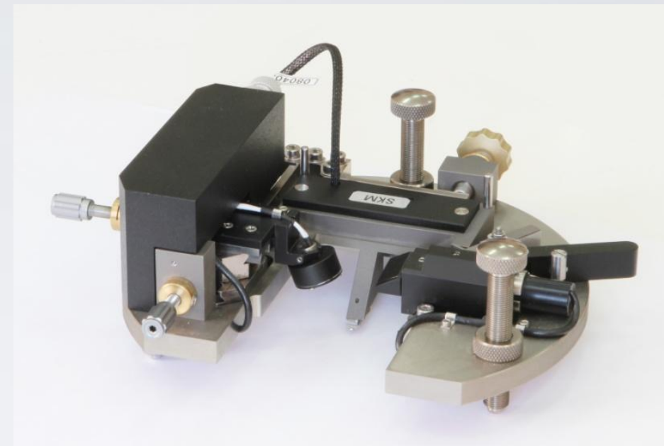
Измерительная АСМ-головка с доступом для параболического зеркала
