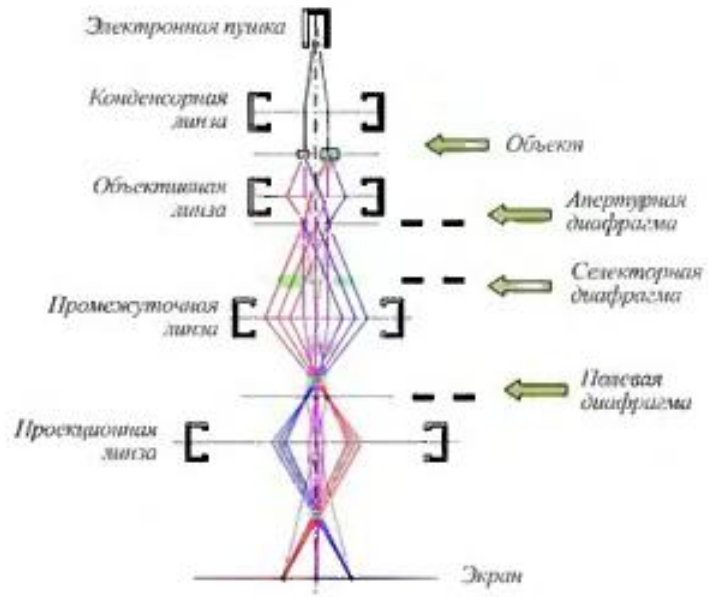
Рис. 5.5. Схема работы ПЭМ в режиме микродифракции
