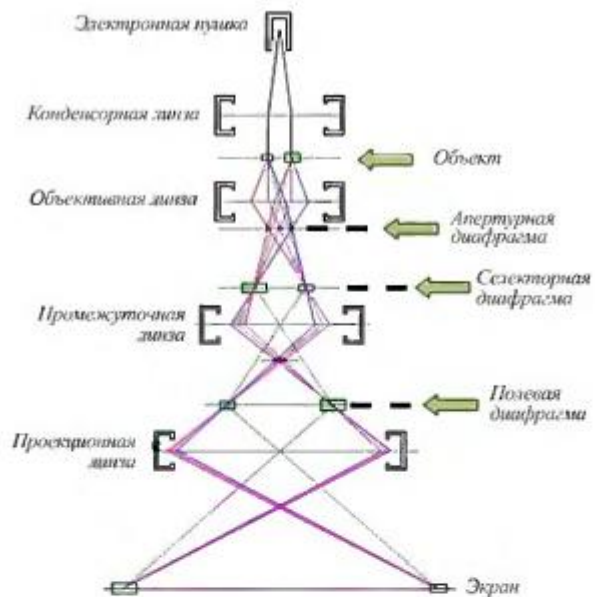
Рис. 5.3. Схема работы ПЭМ в режиме получения микроскопического изображения
