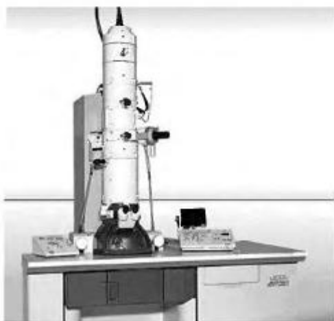
Рис. 5.4. Общий вид просвечивающего электронного микроскопа JEM-1011
