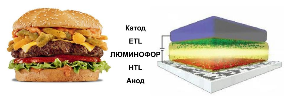
ETL – электронпроводящий слой HTL – дыркопроводящий слой
