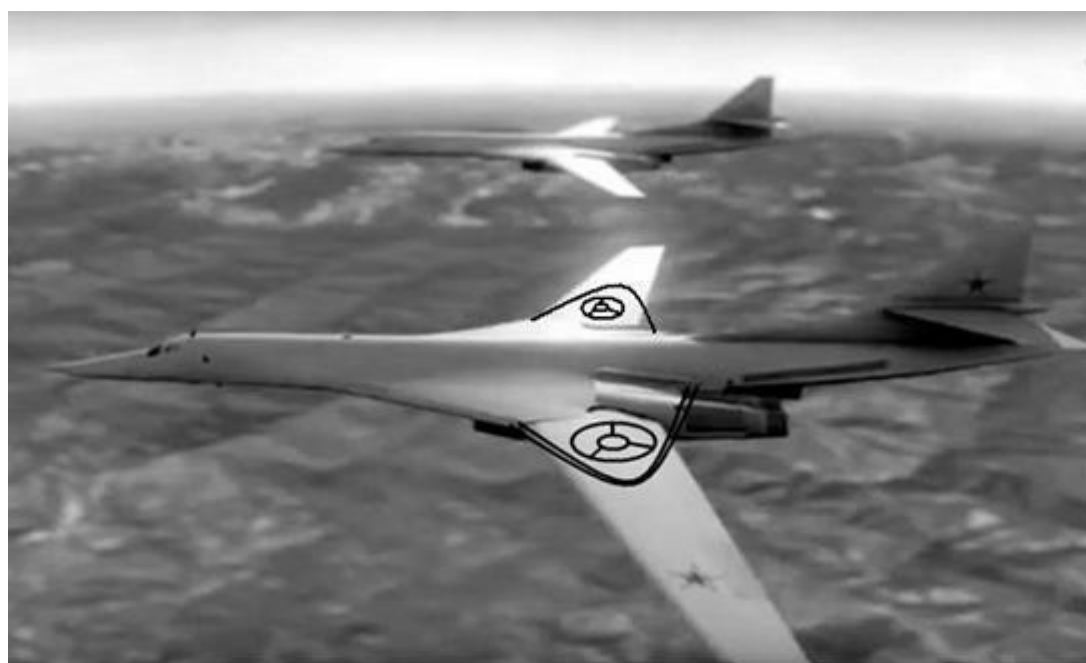
Рис.6. Схема замены у «Белого Лебедя» (Ту-160) громоздкого поворотного крыла на компактное винтокрыло с регулируемым до 0 градусов на сверхзвуковой скорости углом атаки его лопастей.
