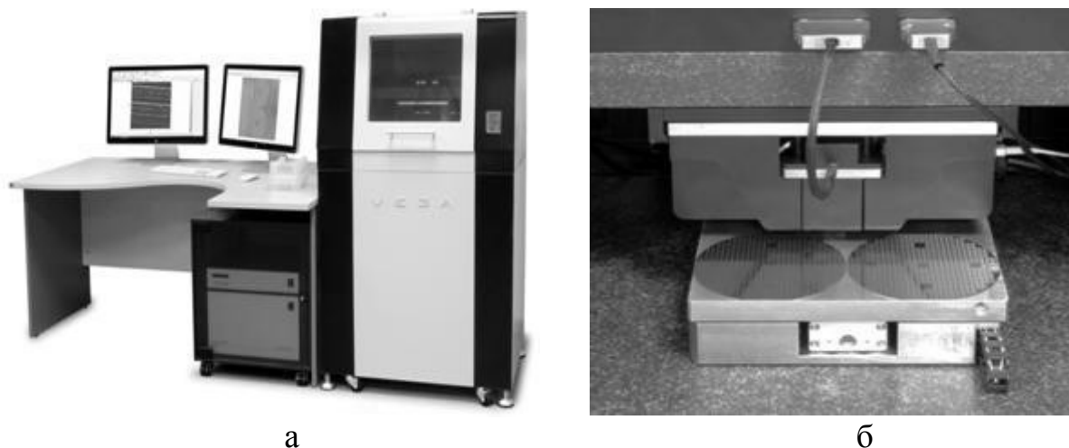
Рис. 9. СЗМ ВЕГА для исследования пластин, диаметром до 200 мм с системой термо- и акустостабилизации (а) с установленными на подвижный стол пластинами диаметром 100 мм (б). Точность поддержания температуры 5 \times 10^{-3} \text{ }^\circ\text{C} , подавление шумов – 30 ДБ
