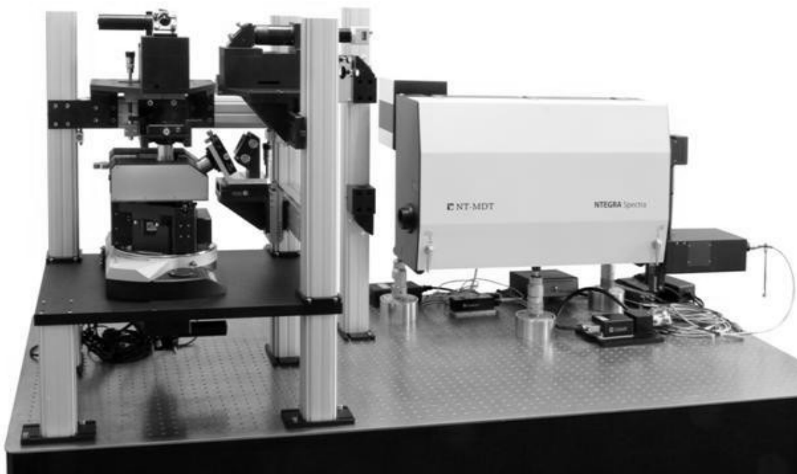
Рис.1. Комбайн сканирующего зондового микроскопа, Рамановского и люминесцентного спектрометра
