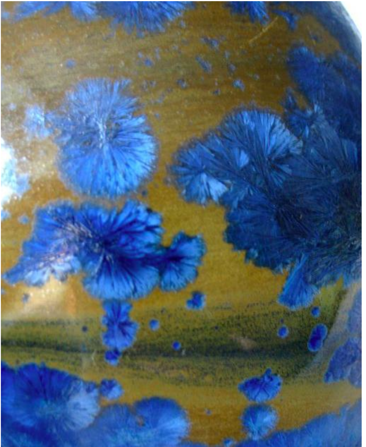
Рис. 7. Сферолиты виллемита, допированные ионами кобальта.
