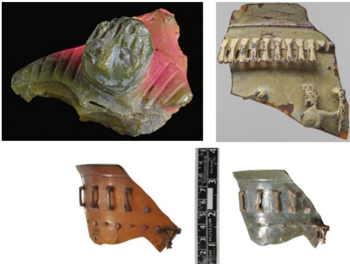
Рис. 9. Античные стекла с дихроизмом. Слева – 5,6 x 6,7 см, Метрополитен музей (коричневая в проходящем свете, оливково-зеленая в отраженном), выщелачивание поверхности. Справа - 6,3 см x 14 см, Британский музей Ag 2270 ppm, Au 13 ppm, внизу - Фрагмент римской диатреты из Duluk Baba Tepesi в отраженном (справа) и проходящем свете. Длина 6,5 см, ширина 9 см. Британский музей
