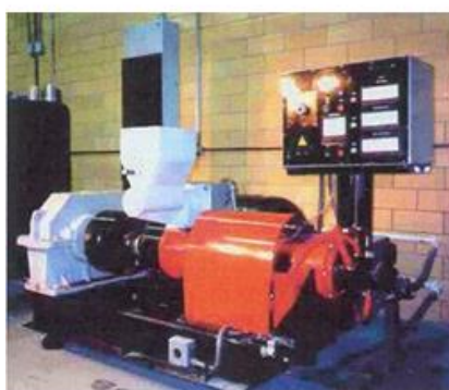
Роторный диспергатор «РОСТ-150А» производства НТЦ «ЭКОРД» на фирме "Hartford Technology" (США)
