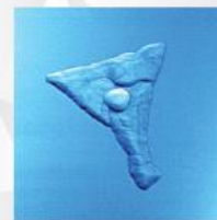
Дефект на поверхности слюды Метод: АСМ, режим трения 10x10 мкм
