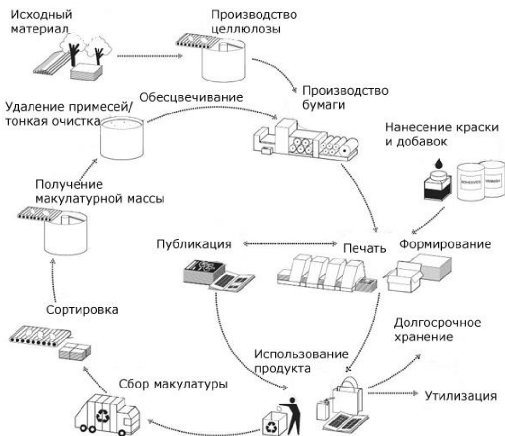
Схема процесса переработки макулатуры в общем цикле производства и потребления бумажной продукции
