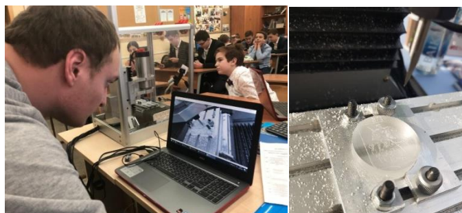
Рис. 9. Трехкоординатный фрезерно-гравировальный станок АТСNano создает герб Москвы на оргстекле под управлением Белова Ю.К.
